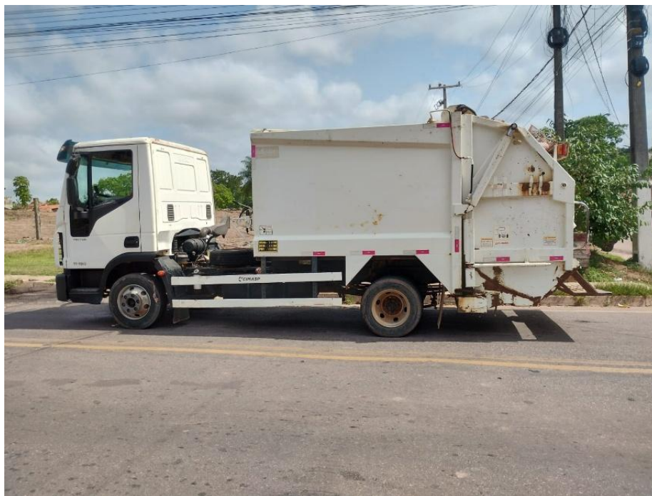
Figura 47- Coletor compactador de resíduos de 4,8 toneladas
