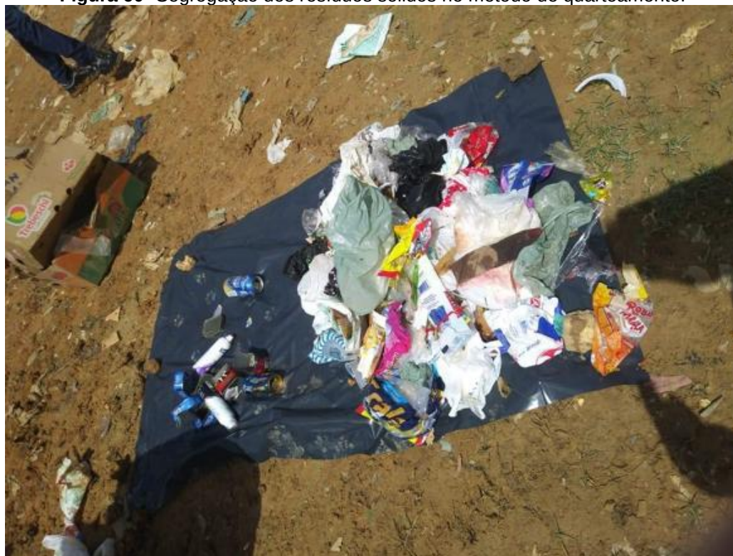
Figura 60- Segregação dos resíduos sólidos no método de quarteamento.
