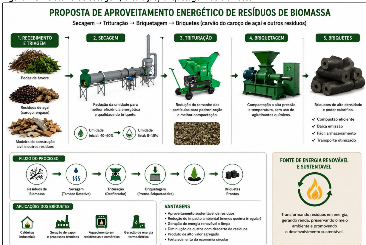
Figura 40 - Sistema de secagem, trituração, briquetagem de biomassa
