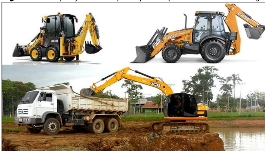
Figura 17 - Proposição das máquinas para limpezas de canais ou córregos
