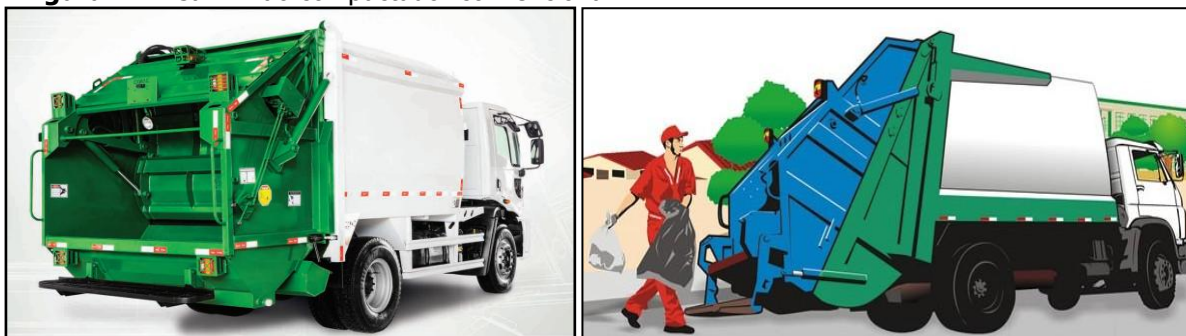
Figura 21 - Caminhão compactador convencional
