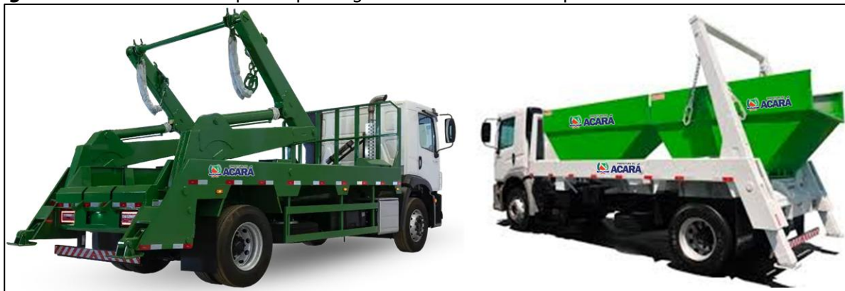
Figura 30 - Modelo de transporte tipo Poliguindaste Double com capacidade mínima de 7t ou até 10 m 3
