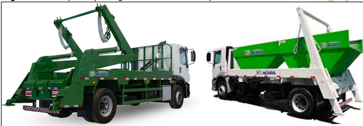
Figura 27- Transporte tipo Poliguindaste Double com capacidade mínima de 7t ou até 10 m 3
