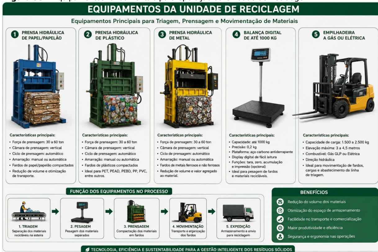
Figura 33 – Equipamentos fundamentais para operação da Unidade de Reciclagem
