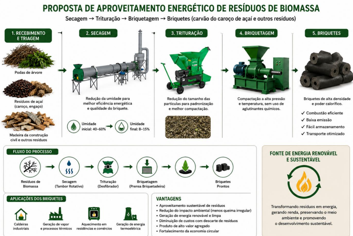
Figura 10 - Sistema de secagem, trituração, briquetagem de biomassa
